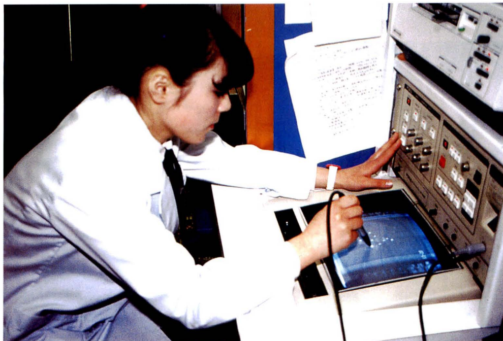
付図4 ビデオデジタイザーによる供試魚の遊泳位置入力
