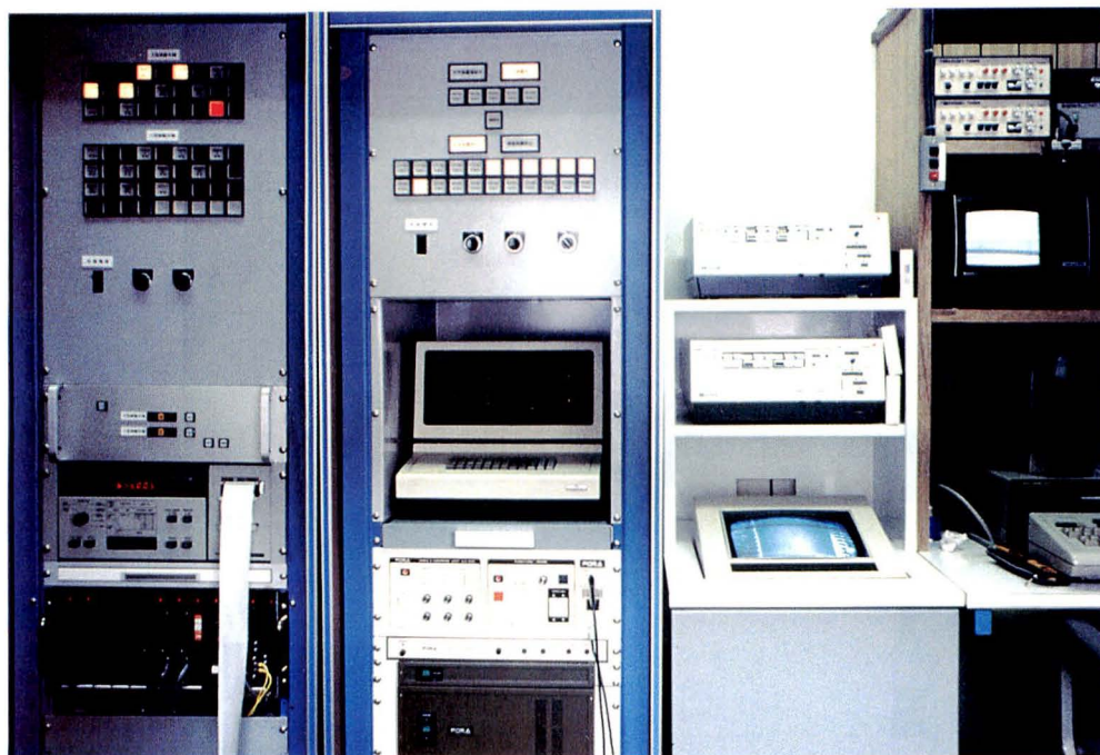
付図3 温度自動制御システムと試験水槽部モニター用テレビ
